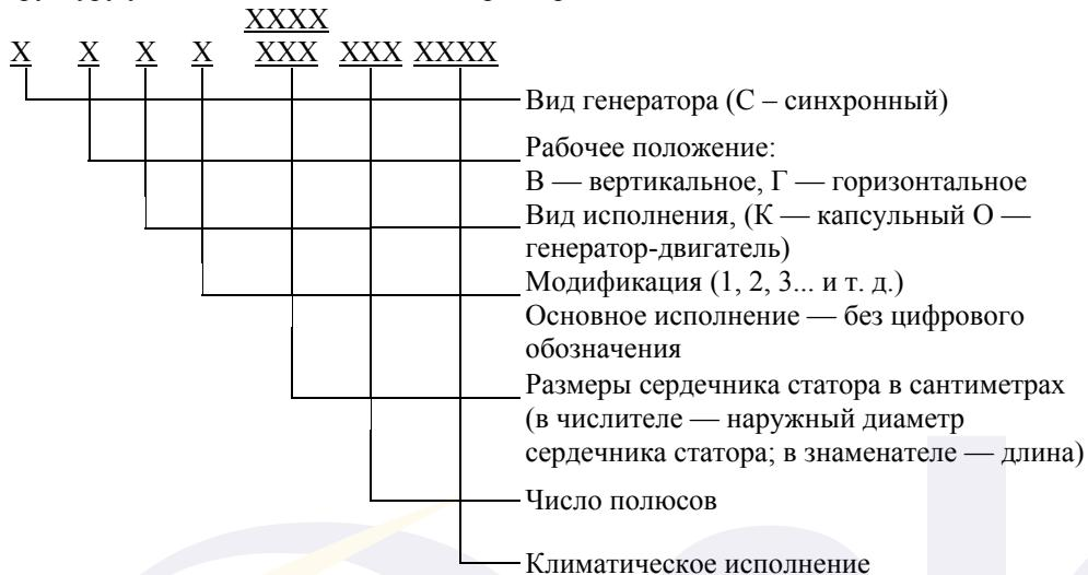
Пример условного обозначения гидрогенератора синхронного, вертикального, основного исполнения, с наружным диаметром сердечника статора 940 см и длиной сердечника статора 235, числом полюсов 30, климатического исполнения УХЛ4:
